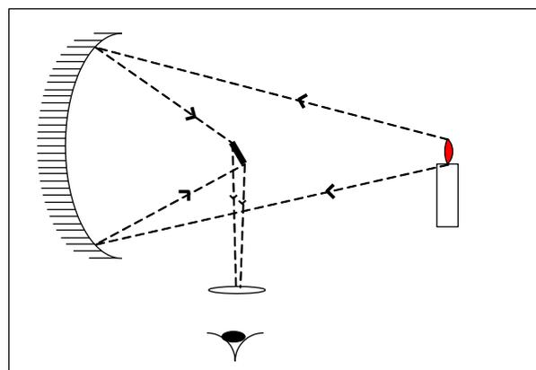
反射望遠鏡の原理を示す実験
