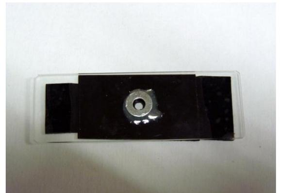
水滴をのせるねじのリングとしぼり、（しぼりに使う穴のあいた黒のプラスチック板はリングと反対側となります）
