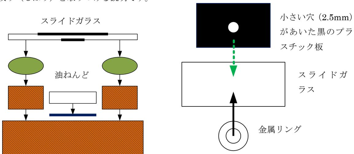
・スライドガラスに金属リング（ねじのワッシャ、リング内径 4 mm）を接着剤（せっちゃくざい）のアドバダイトを使って固定します（今回、内径 4 mm のネジワッシャリングはすでに接着剤でガラスに固定されています）。
