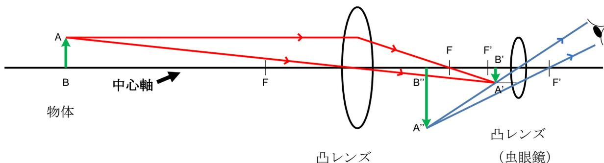
ケプラー式望遠鏡のしくみを説明する図
